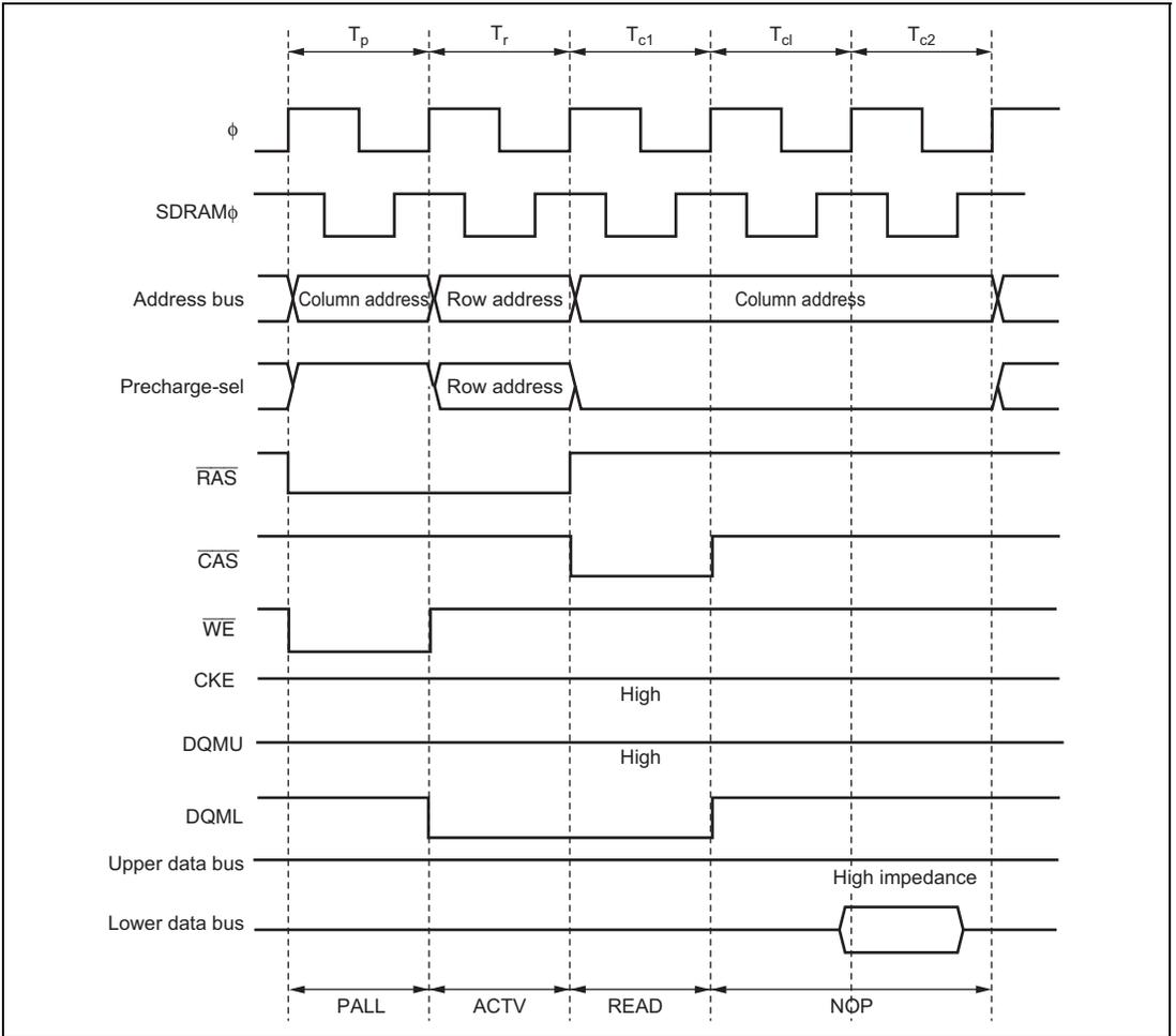
**Figure 6.62 DQMU and DQML Control Timing
