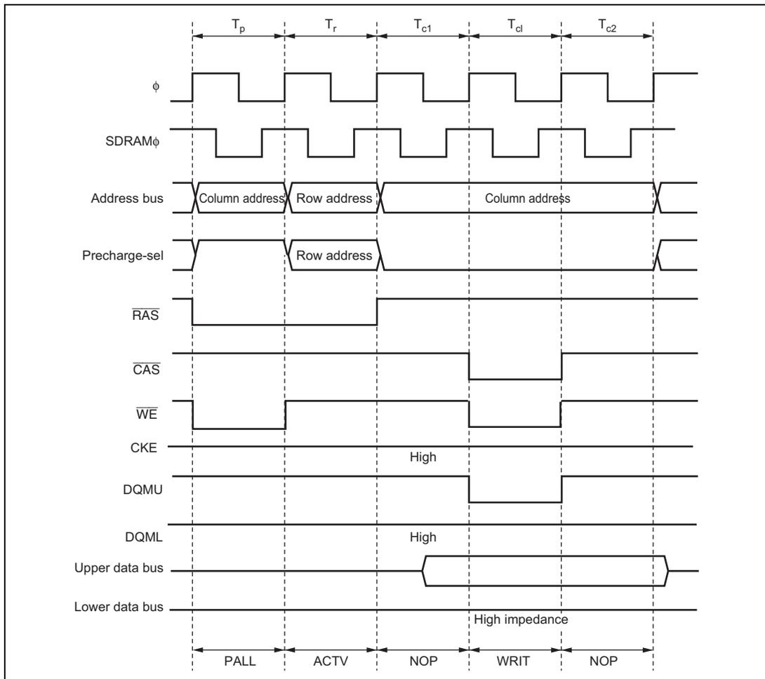
**Figure 6.61 DQMU and DQML Control Timing**
