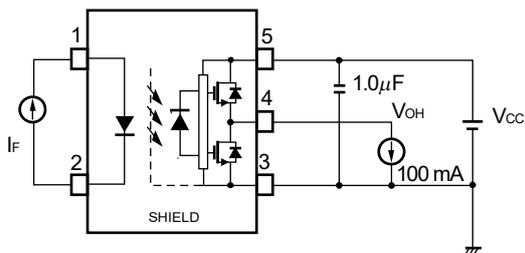
図4  $V_{OL}$ 測定回路
