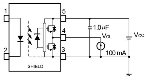
図5  $I_{cCH}/I_{cCL}$ 測定回路
