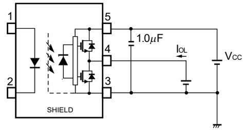
図3  $V_{OH}$ 測定回路
