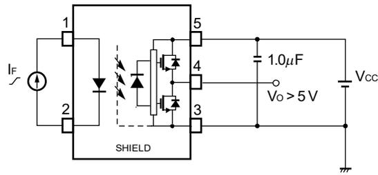
図8 t<sub>PLH</sub>, t<sub>PHL</sub>, t<sub>r</sub>, t<sub>f</sub>測定回路と波形
