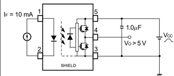
図7 I<sub>FLH</sub>測定回路
