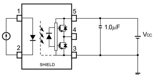
図6 UVLO測定回路
