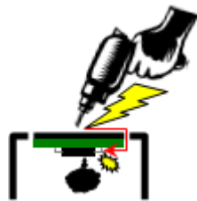
図 5-2 カバーパネル隙間から静電気が回り込むケース
