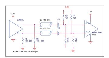
FIGURE 4E. CLK/NCLK INPUT DRIVEN BY 3.3V LVPECL DRIVER WITH AC COUPLE
