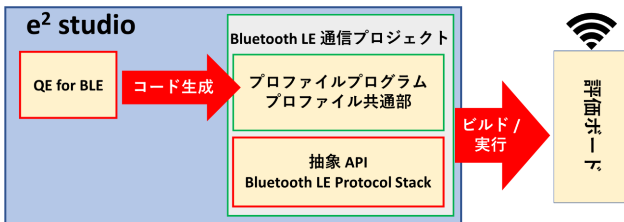
図 1.3 QE for BLE によるプロファイル開発環境 (RX23W, RA4W1 環境)
