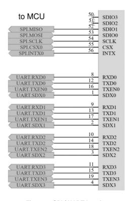
Figure 4. SPI / UART Interface
