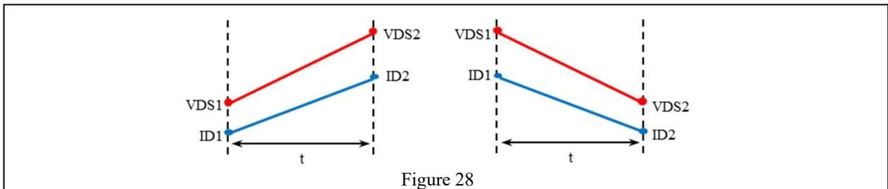
$$P = [1/3 \times \{ (V_{DS2} - V_{DS1}) \times (I_{D2} - I_{D1}) \}] + [1/2 \times \{ (I_{D1} \times V_{DS2}) + (I_{D2} \times V_{DS1}) \}]$$
