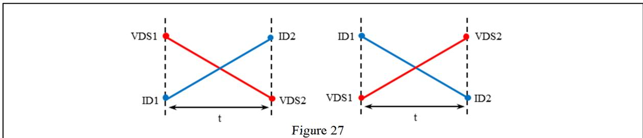
$$P = 1/6 \times \{ (2 \times I_{D1} \times V_{DS1}) + (2 \times I_{D2} \times V_{DS2}) + (I_{D1} \times V_{DS2}) + (I_{D2} \times V_{DS1}) \}$$
