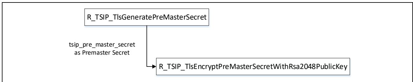
図 2-7 RSA による鍵交換の流れ
