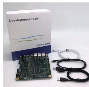
Renesasスターターキット+ for RZ/T2M (型名: RTK9RZT2M0S00000BE) Renesasスターターキット+ for RZ/T2ME (型名: RTK9RZT2M1S00000BE)
