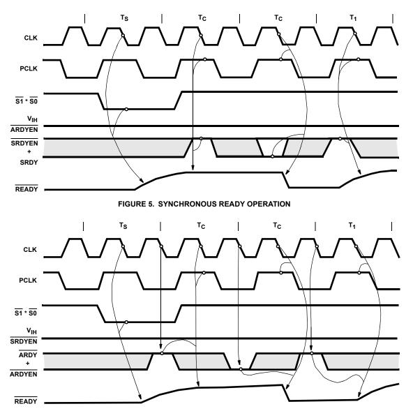
FIGURE 6. ASYNCHRONOUS READY OPERATION
