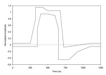
Figure-5 DSX-1 Waveform Template
