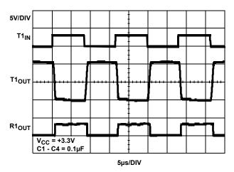
FIGURE 6. LOOPBACK TEST AT 120kbps
