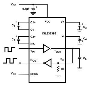
FIGURE 5. TRANSMITTER LOOPBACK TEST CIRCUIT
