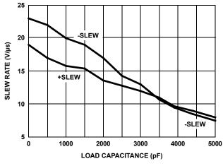
FIGURE 9. SLEW RATE vs LOAD CAPACITANCE
