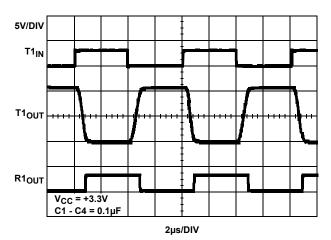
FIGURE 7. LOOPBACK TEST AT 250kbps
