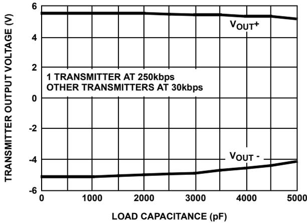
FIGURE 8. TRANSMITTER OUTPUT VOLTAGE vs LOAD CAPACITANCE
