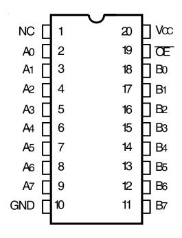
QSOP/ SOIC/ TSSOP TOP VIEW
