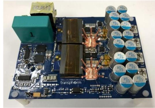
Fig. 8 1.2kW 450kHz LLC Converter
