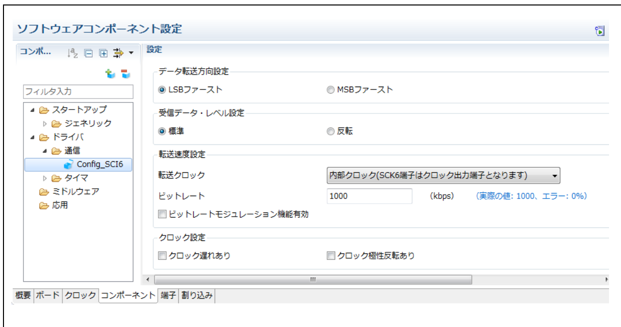
図 2.19 スマート・コンフィグレータのシリアルコミュニケーションインタフェース(SCI6)の設定画面
