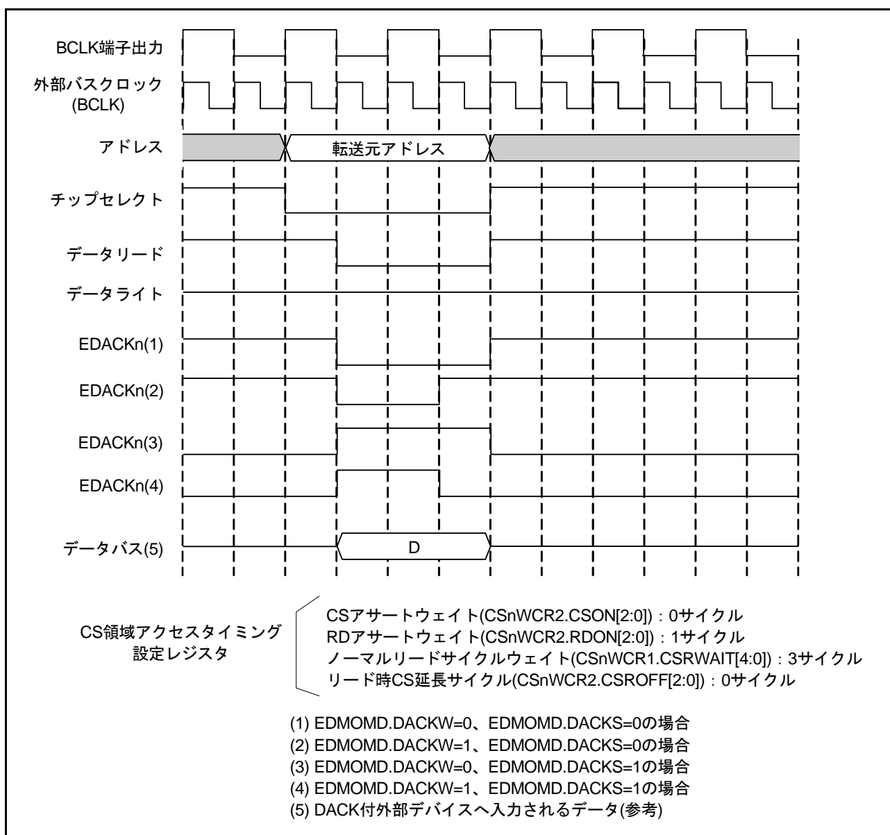
図 19.27 シングルアドレスモードノーマル転送 (CS 領域 リード) 動作例
