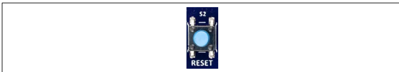
図17 ターゲットボード上のリセットスイッチ（S2）
