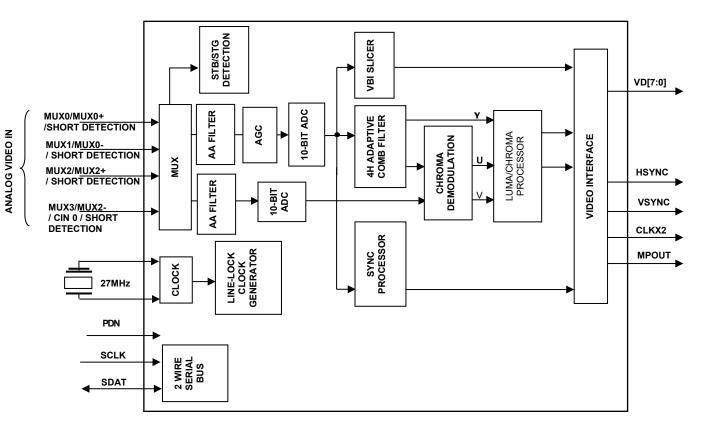
FIGURE 1. TW9990 BLOCK DIAGRAM
