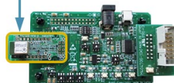
RL78/G1D評価ボード(RTK0EN0001D01001BZ) に装着可。デバッグが容易に出来ます。
