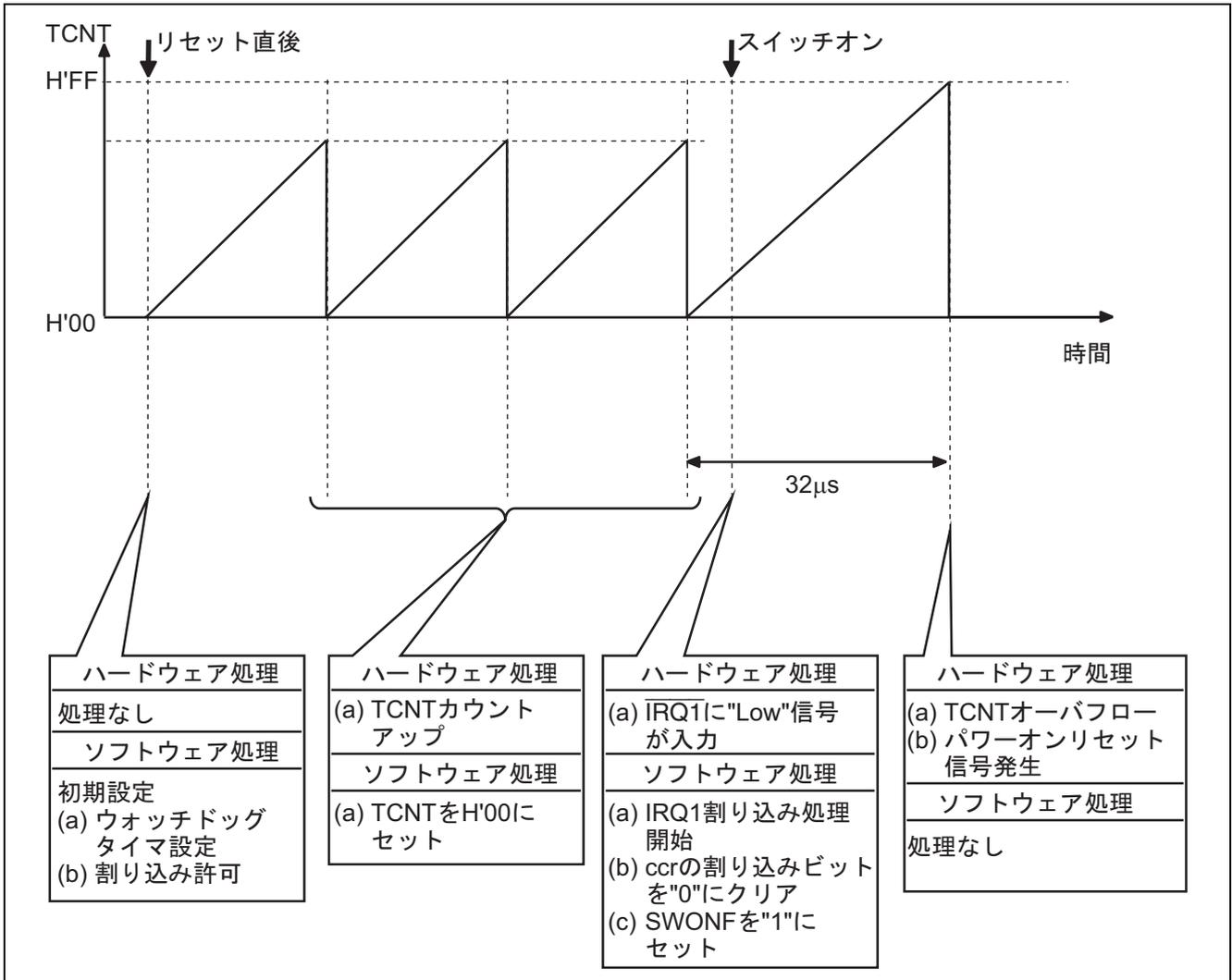
図3 ウォッチドッグタイマ機能によるウォッチドッグ動作説明
