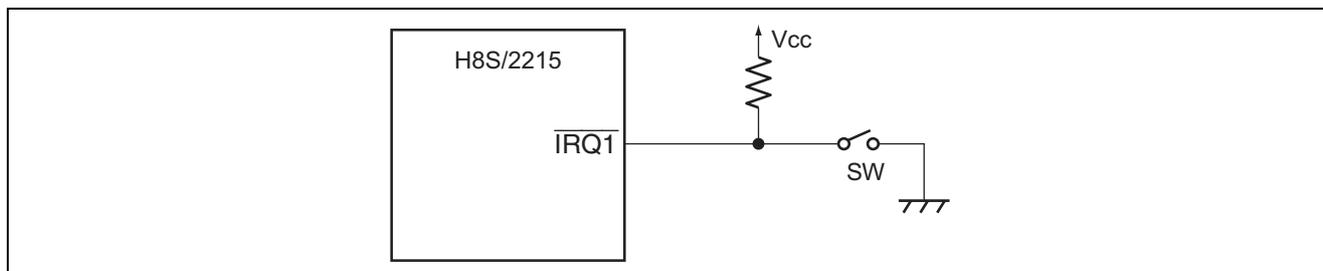
図 1  $\overline{\text{IRQ1}}$  入力端子へのスイッチ接続例
