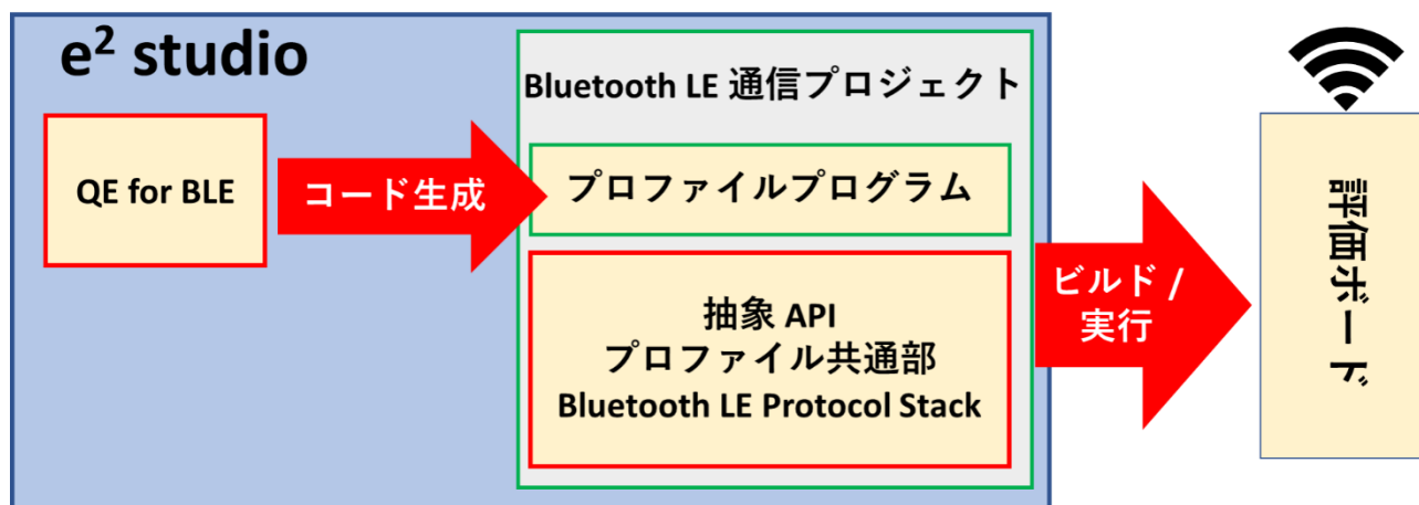
図 1.2 QE for BLE によるプロファイル開発環境 (RE01B 環境)
