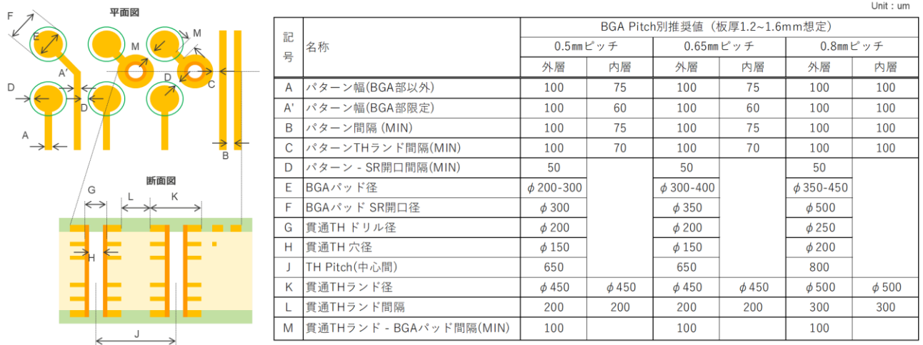
図 8. 貫通基板における推奨基板設計ルール
