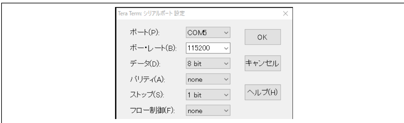
図 79 UART インタフェース使用時のボー・レート設定
