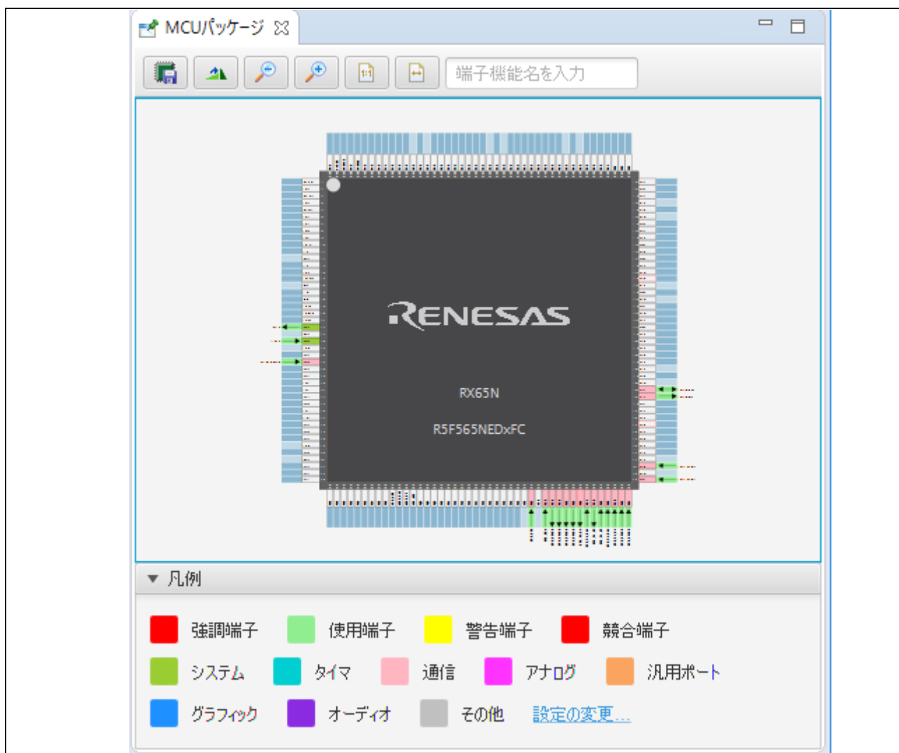
図 2-20 MCU パッケージの端子配置
