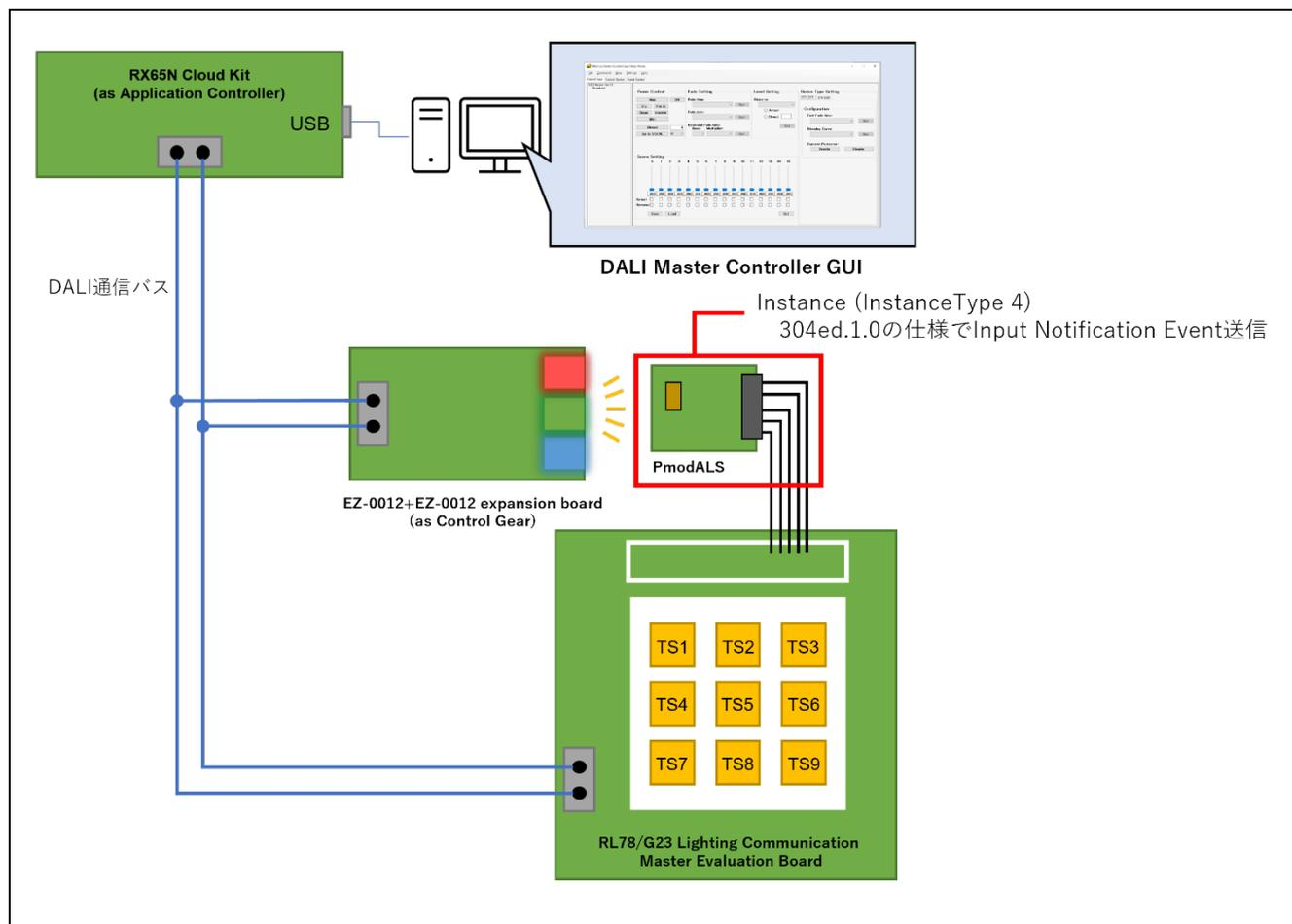
本サンプルアプリケーションは DALI 規格における Input Device 機器として動作します。本サンプルアプリケーションにおける Input Device は Instance Type 4 の Instance を 1 つ保有しており、Instance は Light Sensor と対応付いています。Instance – 入力装置対応表を表 4.7 に記載します。
