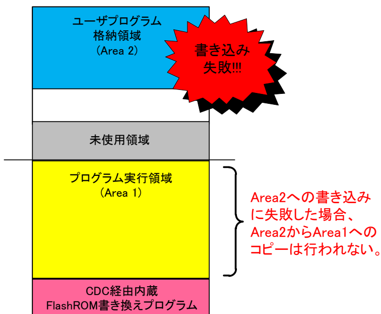
Figure 8-5 ユーザプログラムの更新失敗
