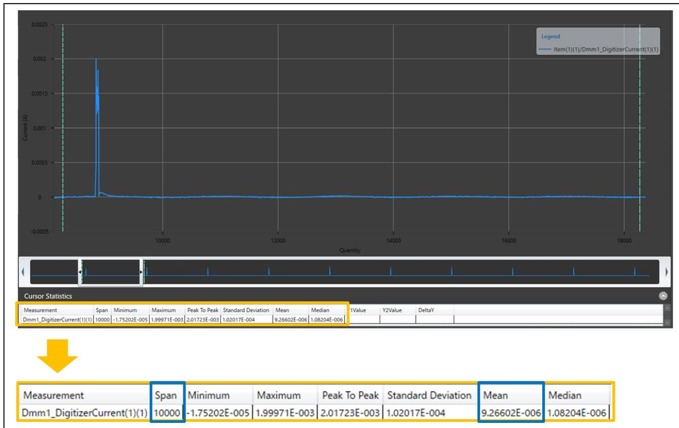
図 6.7 スタンバイモードの消費電流結果
