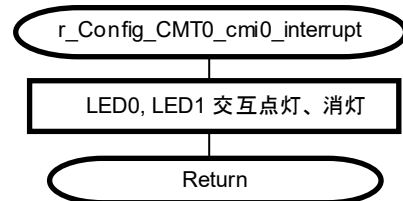
図 2-4 : タイマ割り込み動作フロー
