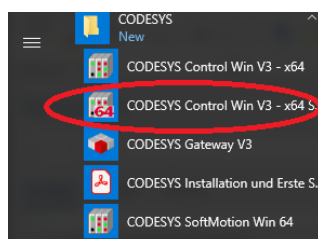
図 3.3 PLC コントローラ起動
