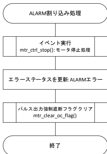
Figure 3-10 フローチャート(ALARM 割り込み処理)
