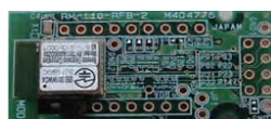
モジュール評価ボード (型名:RM-110-RFB-2) (2.54mmピッチの端子ホール付き) ブレッドボードに搭載可 早期の評価、開発向けに 内藤電誠町田製作所から販売
