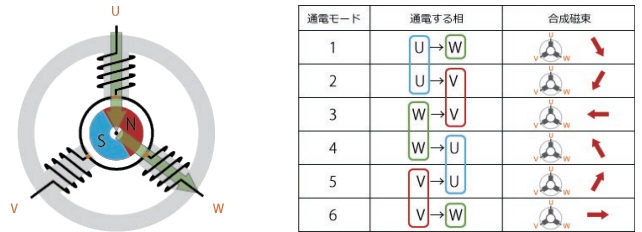
120度通電制御の通電パターンイメージ
