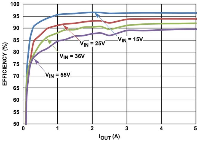
図 8. 効率 (+125 °C) : DE モード、 $V_{OUT} = 12V$ 、 $L = 4.7\mu H$ 、 $f_{SW} = 300k\Omega$
