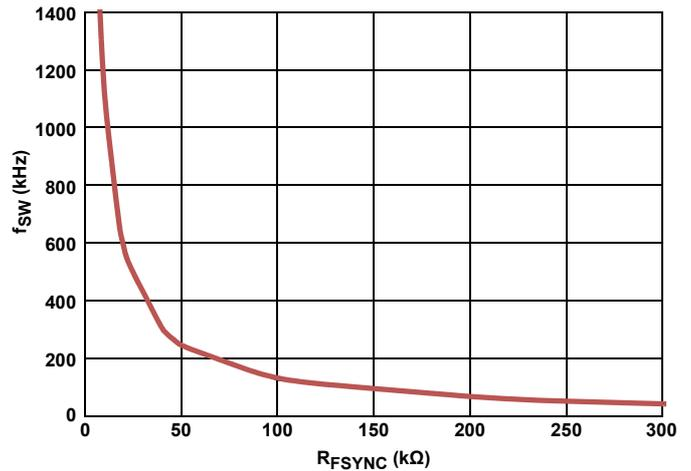
図 40.  $R_{FSYNC}$  vs  $f_{SW}$
