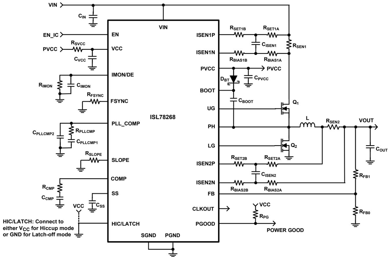
図 3. 同期整流型降圧、平均定電流 I<sub>OUT</sub>
