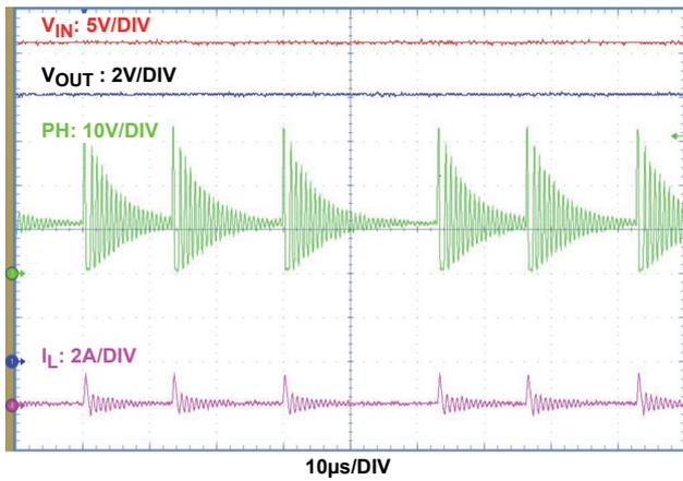
図 12. DE モード :  $V_{IN} = 36V$ ,  $V_{OUT} = 12V$ ,
