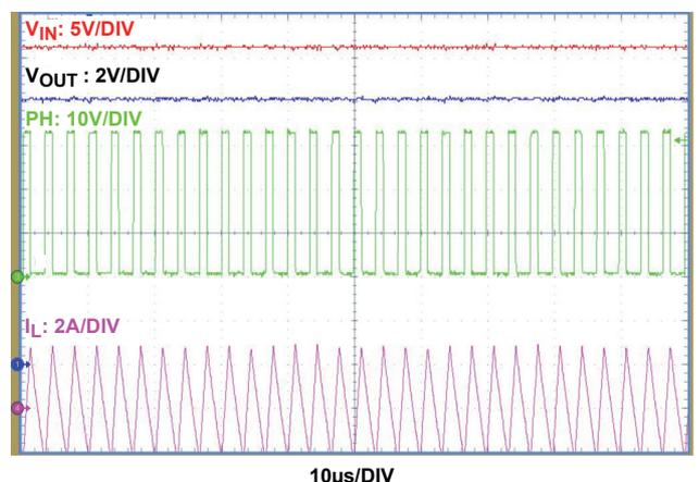
図 15. 強制 PWM モード :  $V_{IN} = 36V$ ,  $V_{OUT} = 12V$ ,
