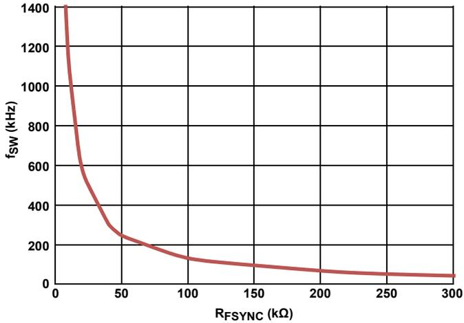
図 6. 周波数設定 (+25 °C)、 $V_{IN} = 36V$
