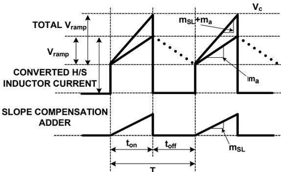
図 51. 変換されたセンス電流の波形
