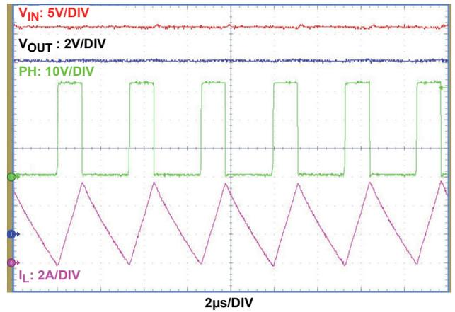
図 13. 強制 PWM モード :  $V_{IN} = 36V$ ,  $V_{OUT} = 12V$ ,
