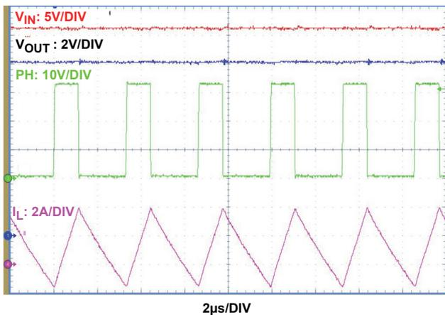
図 14. 強制 PWM モード :  $V_{IN} = 36V$ ,  $V_{OUT} = 12V$ ,
