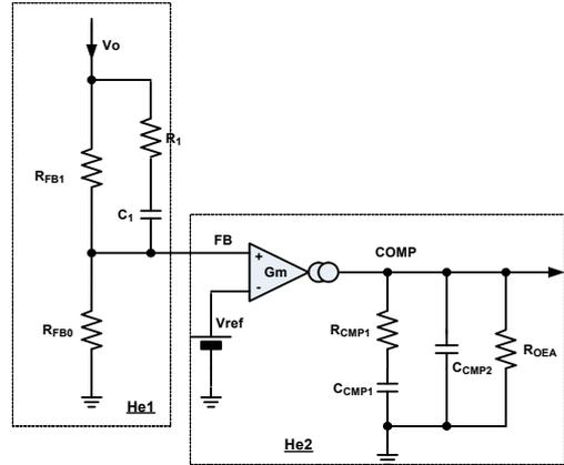
図 52. タイプ III 補償回路
