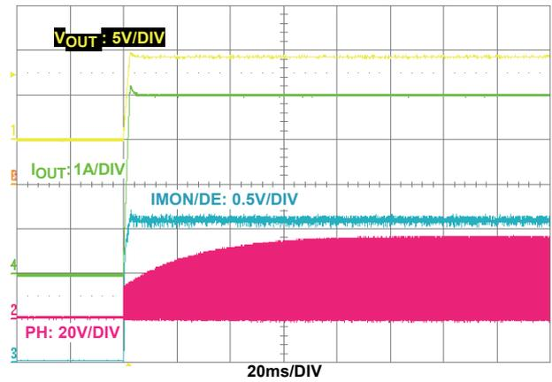
図 37. 平均定電流制御 :  $V_{IN} = 36V$ 、
