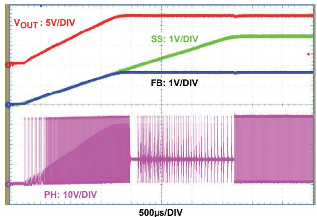
図 23. ソフトスタート (プリバイアスなし)：強制 PWM モード、 $V_{IN} = 36V$ 、 $V_{OUT} = 12V$ 、 $I_{OUT} = 0A$ 、 $L = 4.7\mu H$ 、 $C_{OUT} = 98\mu F$ 、 $f_{SW} = 300kHz$
