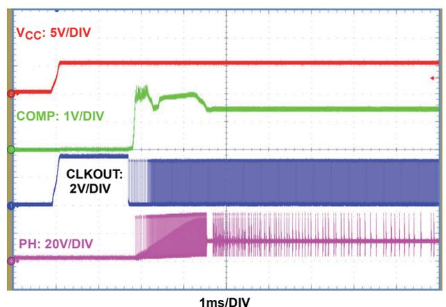
図 17. 初期化～スタートアップ : DE モード,  $V_{IN} = 36V$ ,
