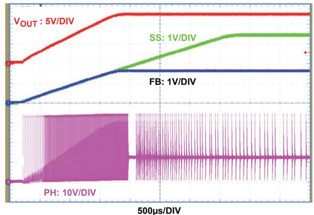
図 21. ソフトスタート (プリバイアスなし)：DE モード、 $V_{IN} = 36V$ 、 $V_{OUT} = 12V$ 、 $I_{OUT} = 0A$ 、 $L = 4.7\mu H$ 、 $C_{OUT} = 98\mu F$ 、 $f_{SW} = 300kHz$
