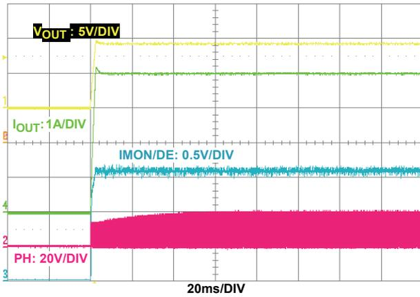
図 36. 平均定電流制御 :  $V_{IN} = 20V$ 、
