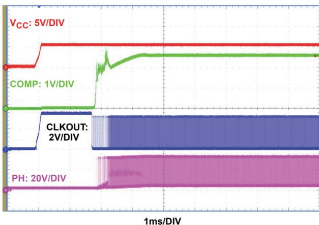
図 16. 初期化～スタートアップ : DE モード,  $V_{IN} = 36V$ ,
