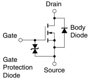
備考 本製品のゲート - ソース間に内蔵されている保護ダイオードは、取り扱い時における静電気保護用です。実使用回路において、ゲート - ソース間に過大な電圧が印加される恐れがある場合には、保護回路をつけてご使用ください。
