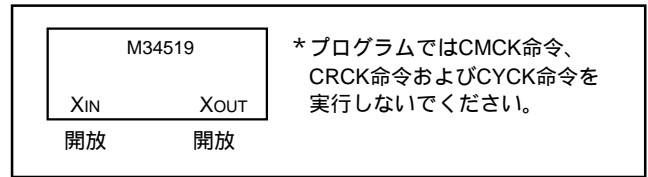
図WA-3. オンチップオシレータ動作時の XIN 、 XOUT 端子の処理
