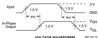
VOLTAGE WAVEFORMS PROPAGATION DELAY TIMES
