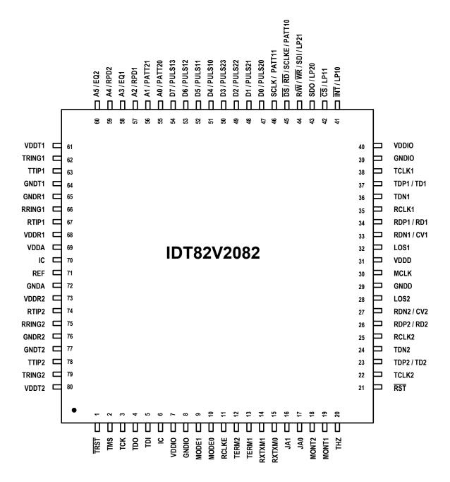
Figure-2 IDT82V2082 TQFP80 Package Pin Assignment
