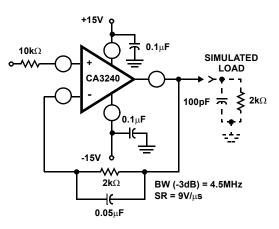
FIGURE 1C. TEST CIRCUIT
