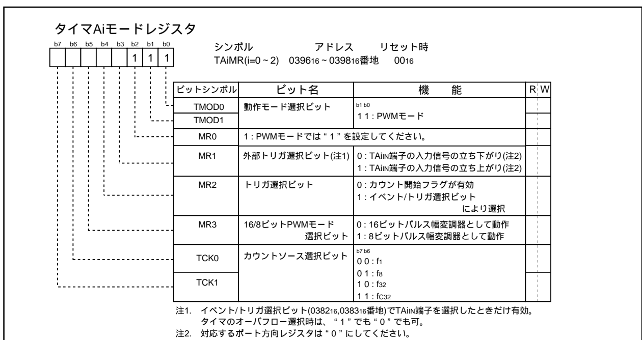
図1.14.11. パルス幅変調モード時のタイマAiモードレジスタの構成
