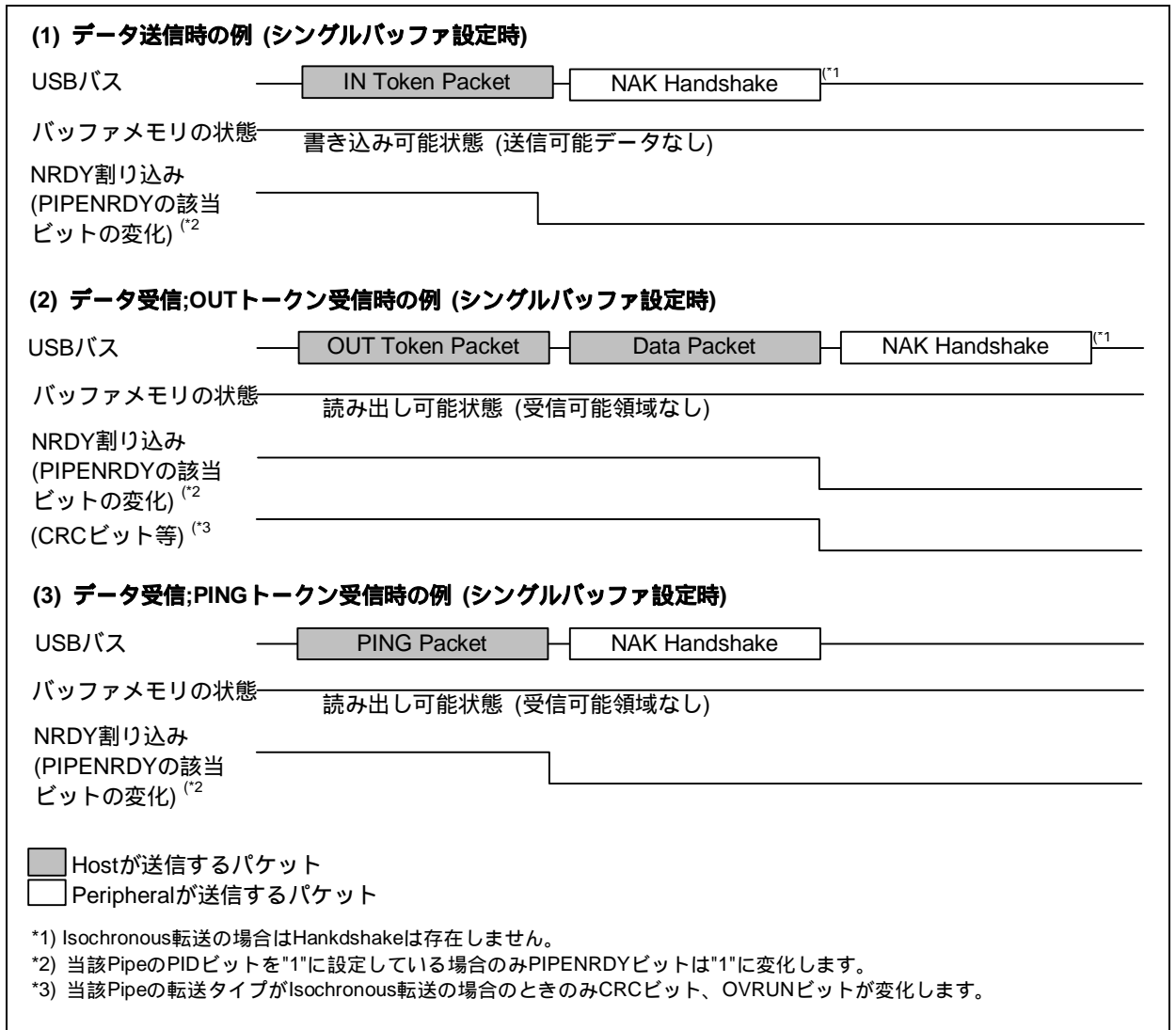
図 3.8 Peripheral Controller機能選択時のNRDY割り込み発生タイミング図
