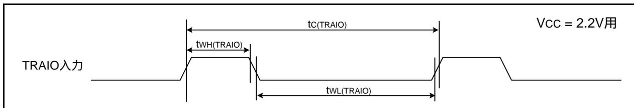
図5.17  $V_{CC} = 2.2V$ 時のTRAIO入力タイミング
