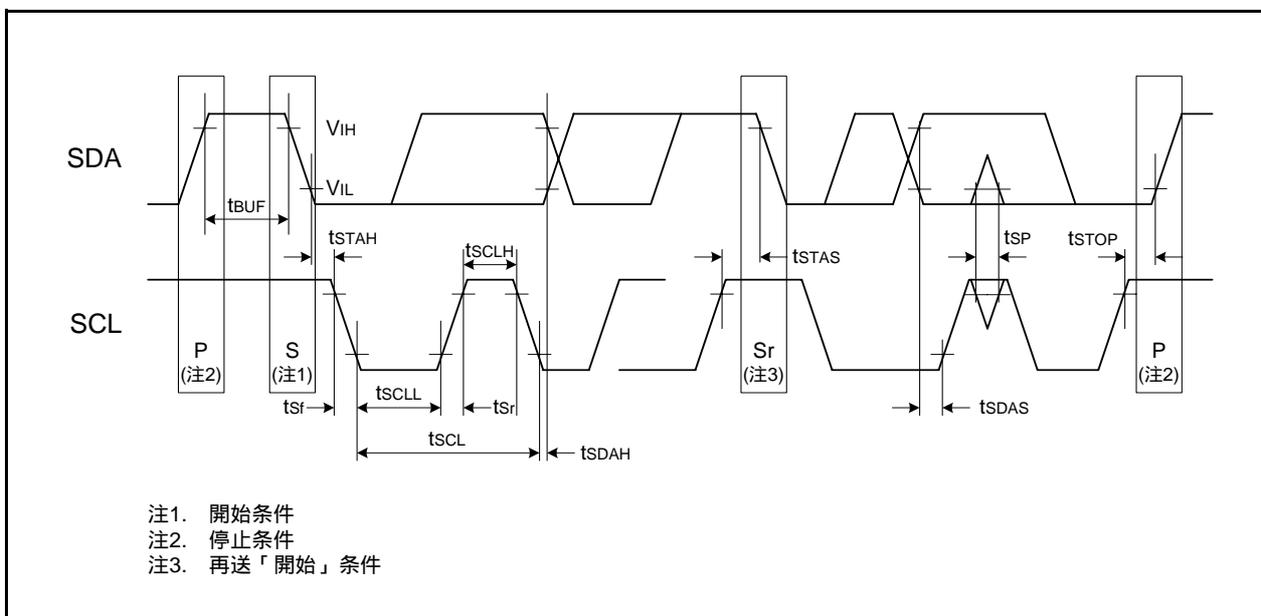
図5.7 I<sup>2</sup>Cバスインタフェースの入出力タイミング
