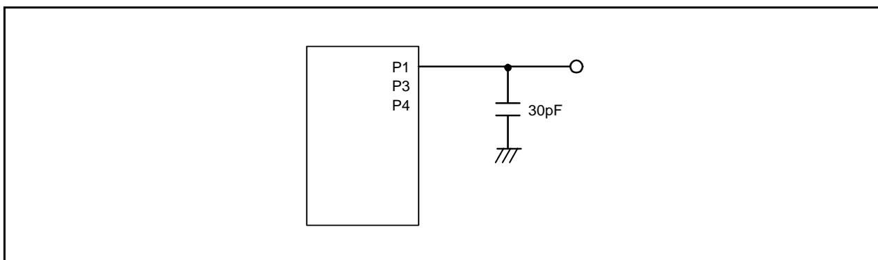
図5.1 ポートP1、P3、P4のタイミング測定回路
