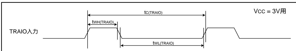
図5.13  $V_{CC} = 3V$ 時のTRAI0入力タイミング
