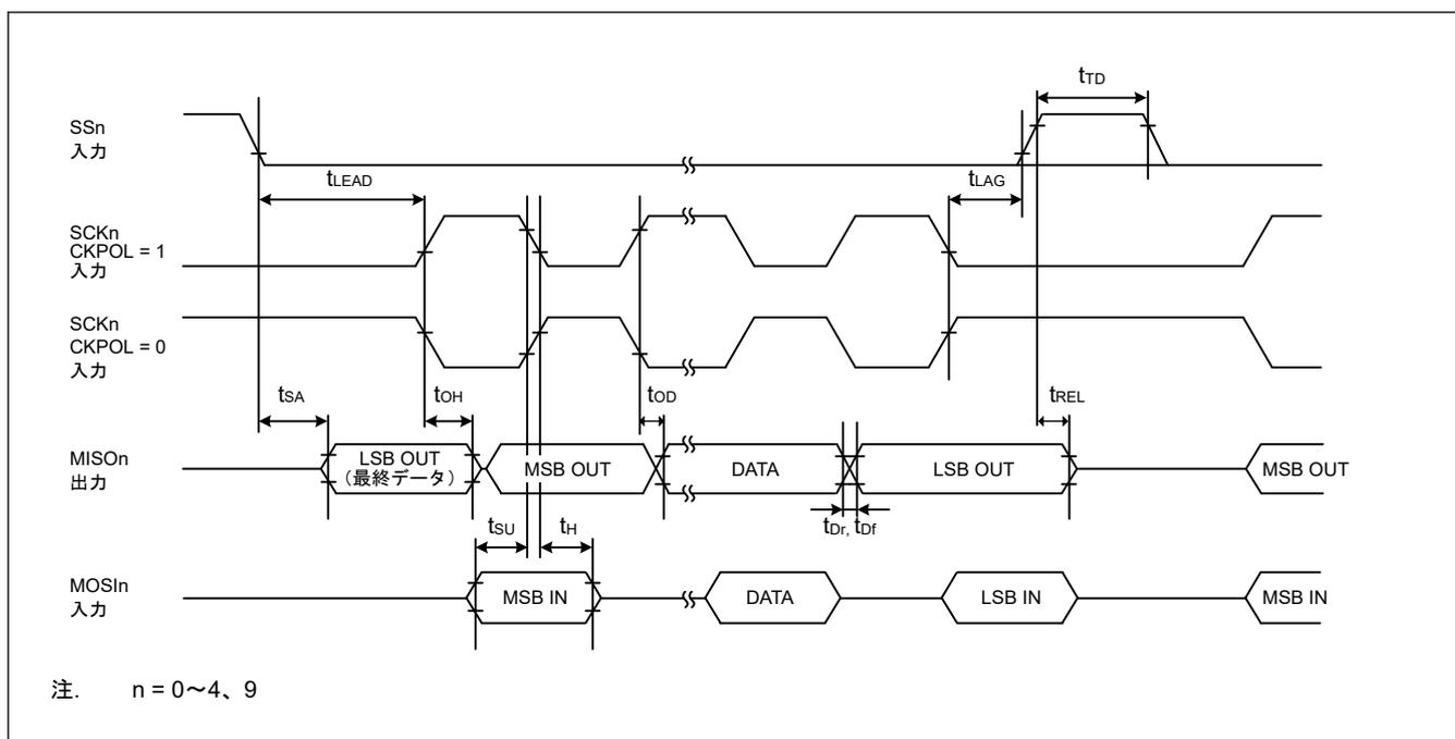
図 2.37 CKPH = 0 の場合におけるスレーブの SCI 簡易 SPI モードタイミング
