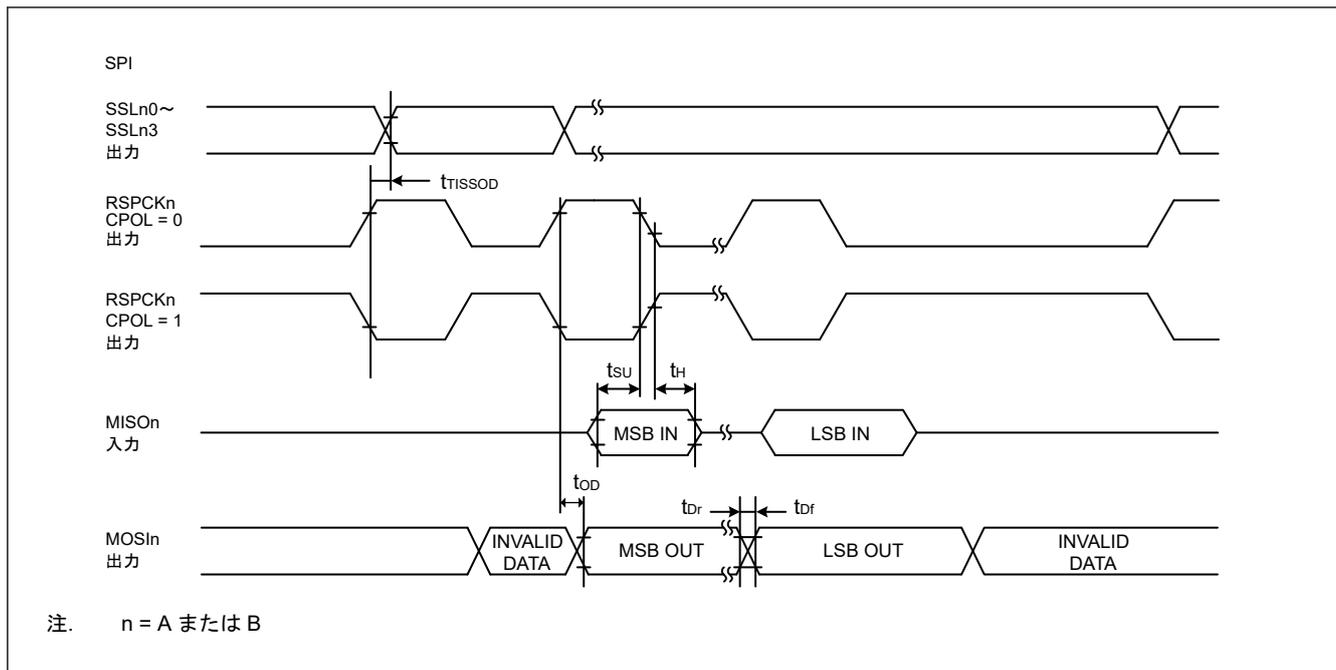
図 2.42 SPI タイミング (TI SSP マスタ)
