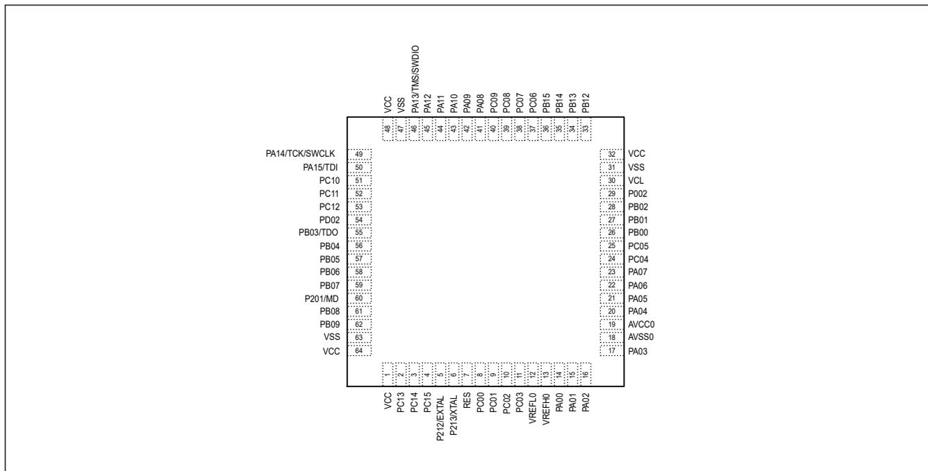
図 1.5 64 ピン QFN のピン配置
