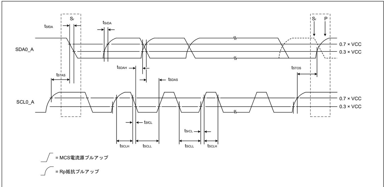
図 2.48 I<sup>2</sup>C バスインタフェース入出力タイミング (Hs モード)
