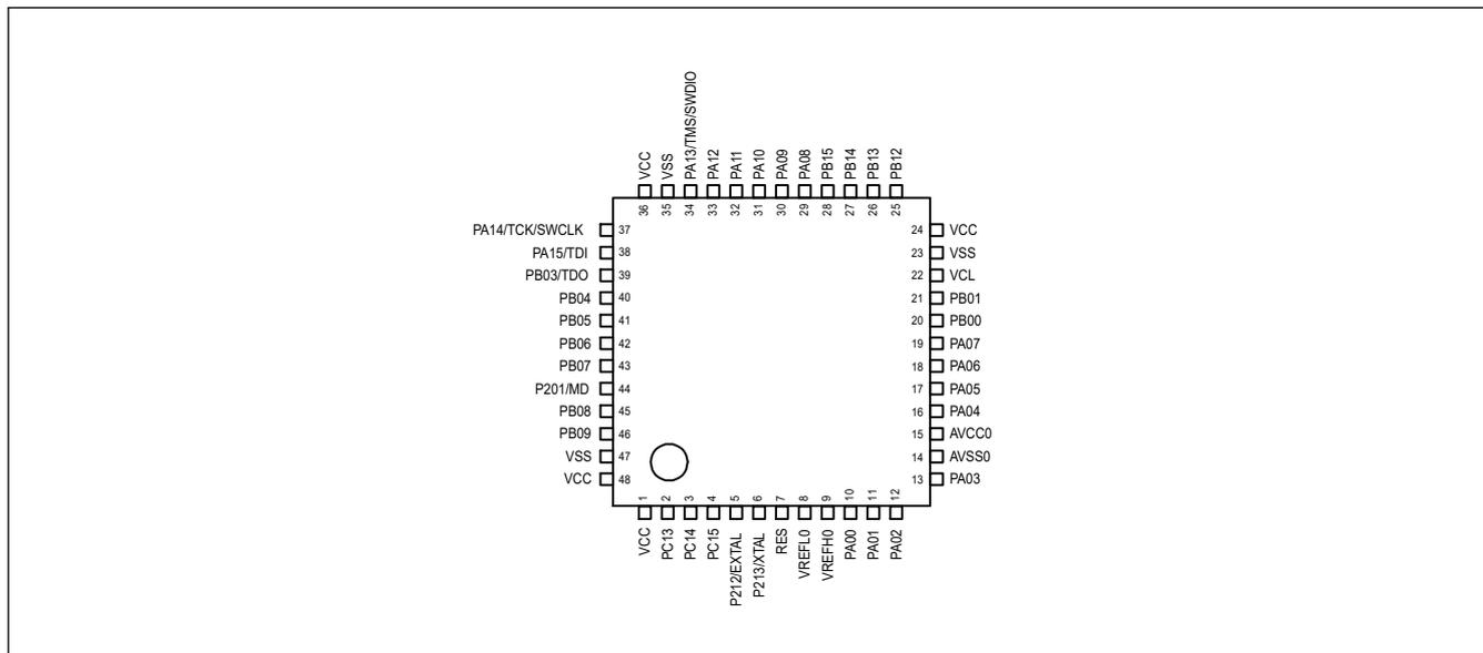
図 1.6 48 ピン LQFP のピン配置
