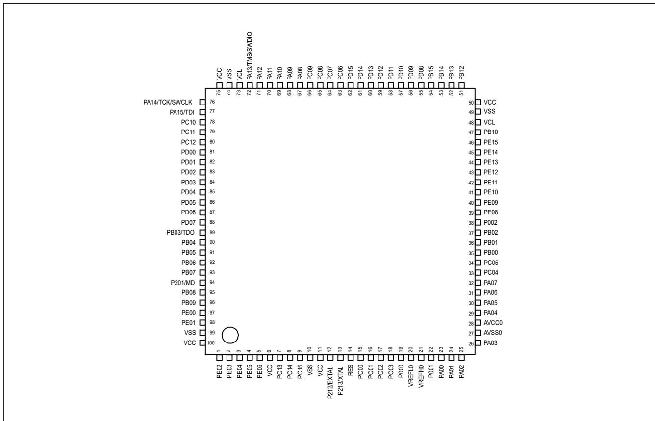
図 1.3 100 ピン LQFP のピン配置
