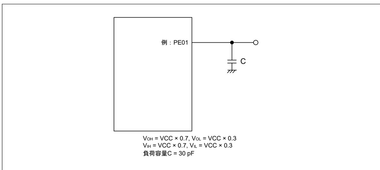
図 2.1 入出力タイミング計測条件
