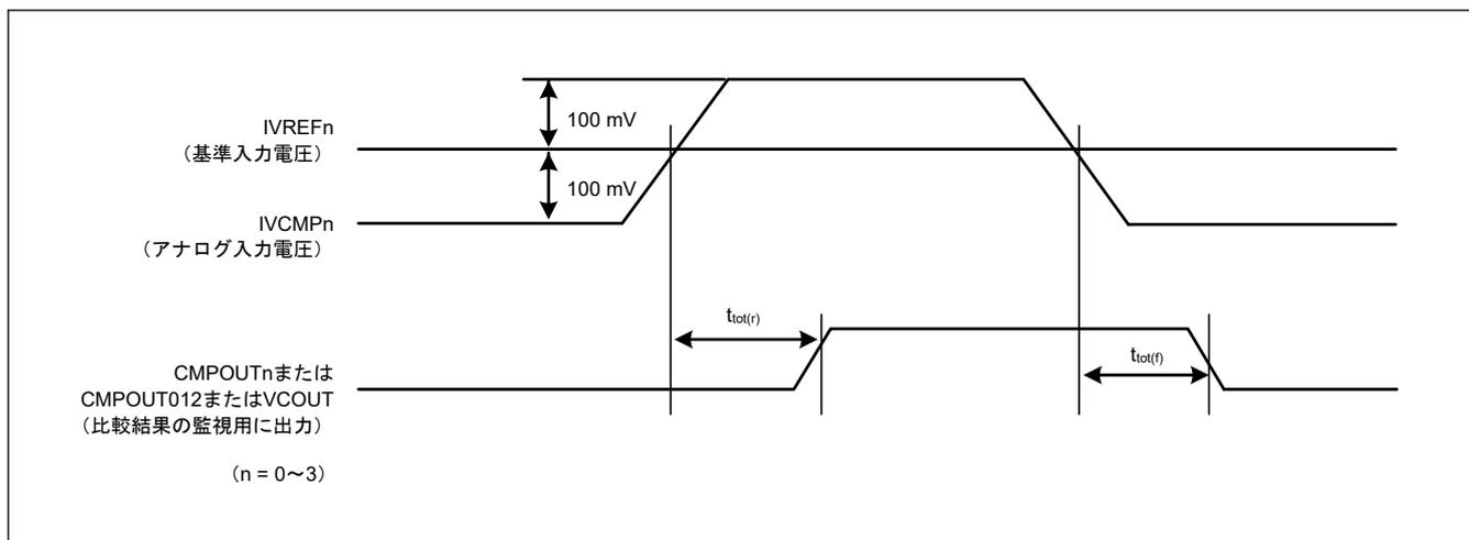
図 2.52 コンパレータ応答時間
