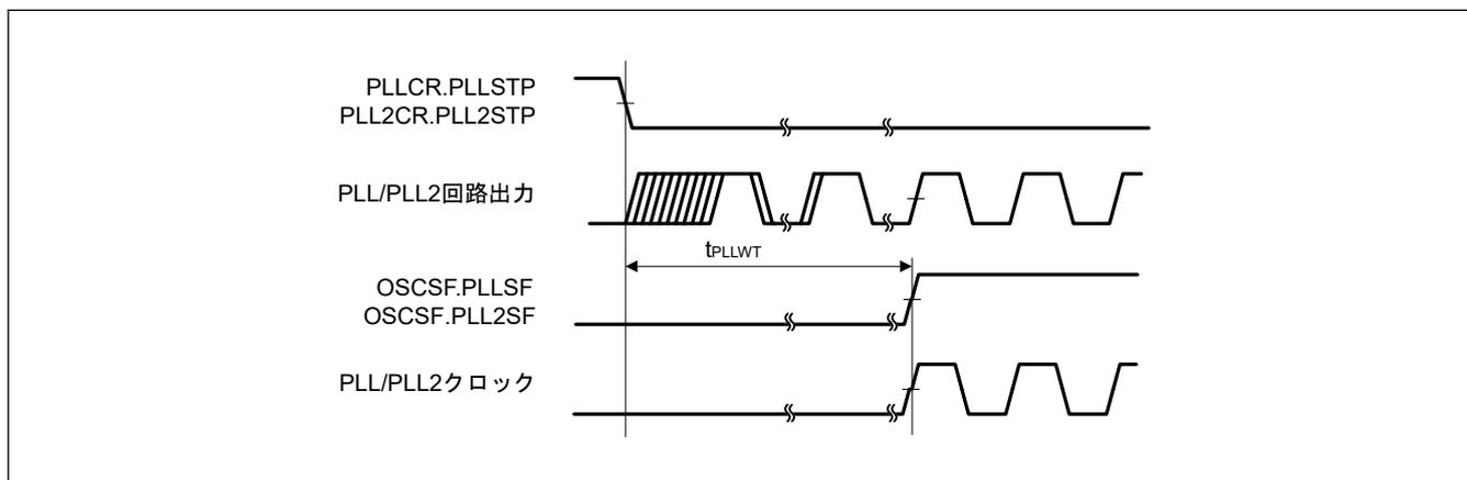
図 2.6 PLL/PLL2 クロック発振開始タイミング
