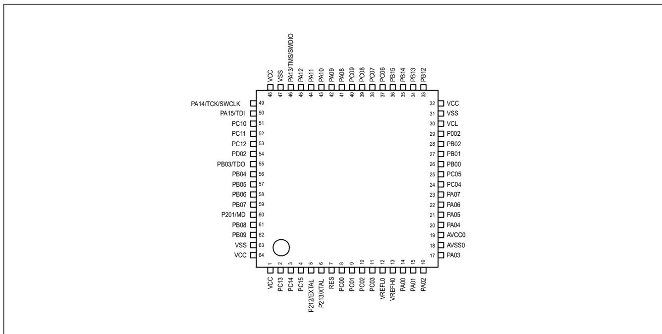
図 1.4 64 ピン LQFP のピン配置
