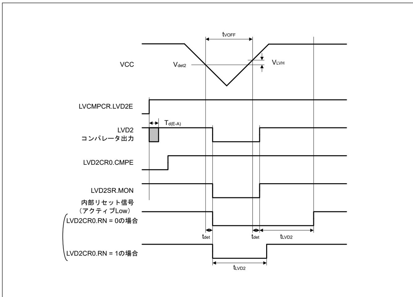
図 2.58 電圧検出回路タイミング ( $V_{det2}$ )
