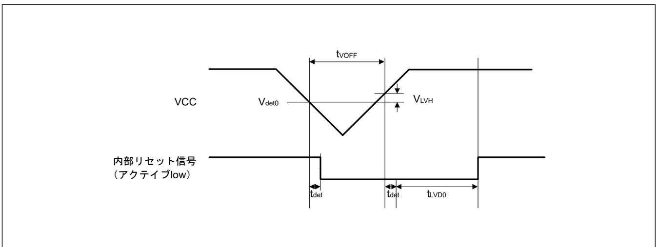
図 2.56 電圧検出回路タイミング ( $V_{det0}$ )
