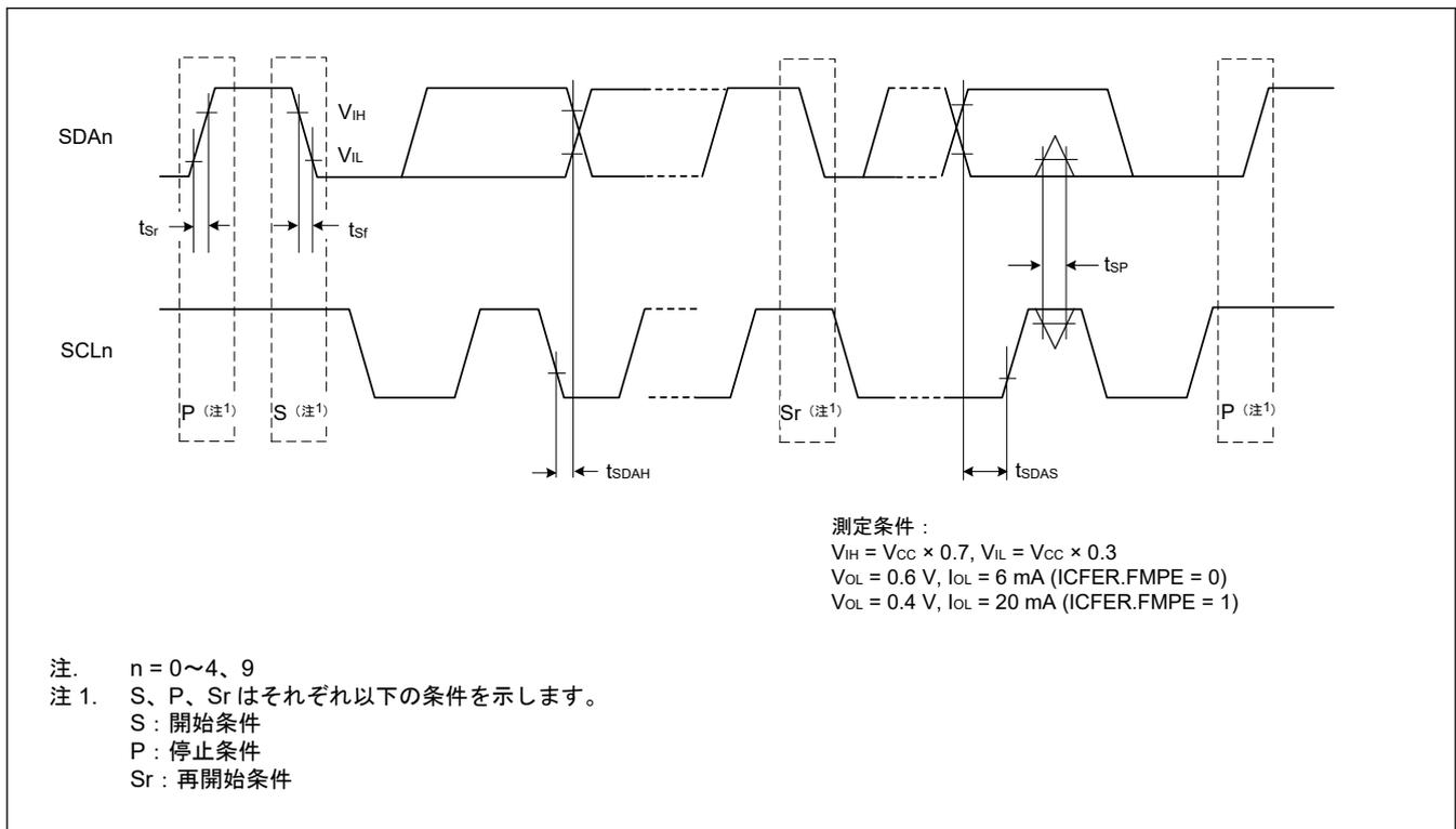
図 2.38 SCI 簡易 IIC モードタイミング
