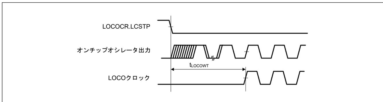
図 2.5 LOCO クロック発振開始タイミング
