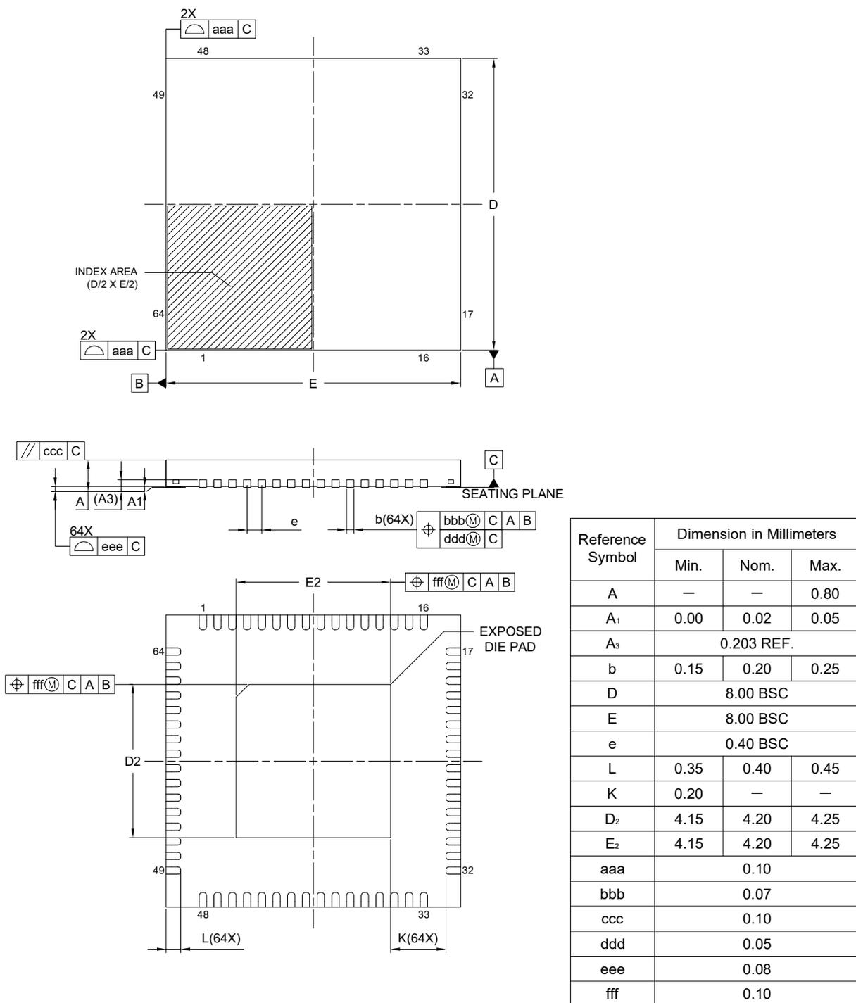
図 2.3 QFN 64 ピン
