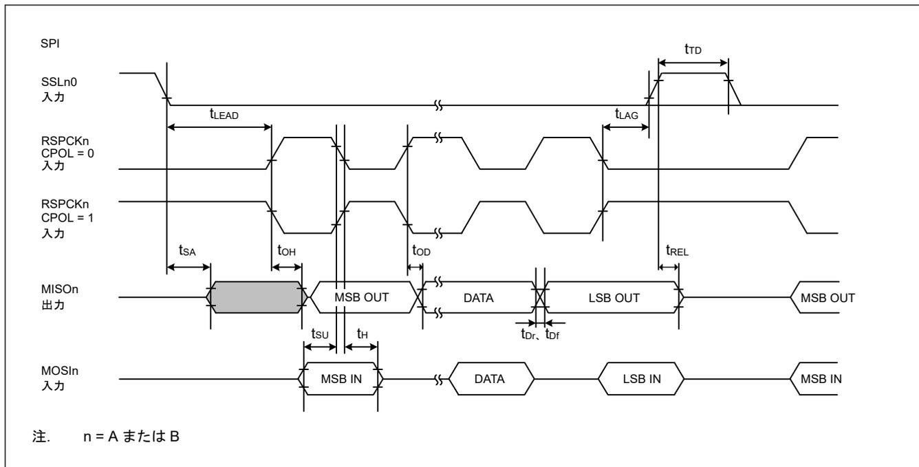
図 2.44 CPHA = 1 の場合におけるモトローラ SPI スレーブの SPI タイミング
