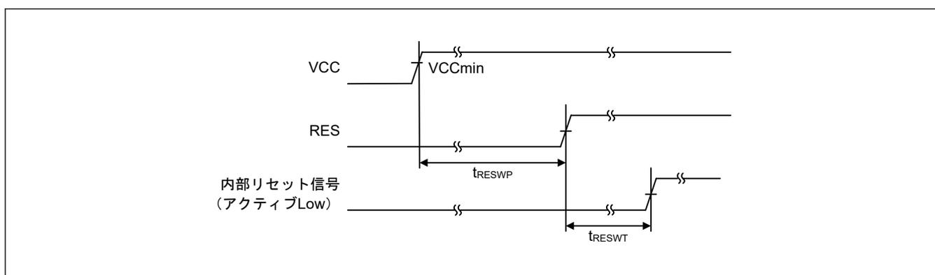
図 2.7 VCC が  $V_{POR}$  電圧しきい値を超える条件下での RES 端子入力タイミグ
