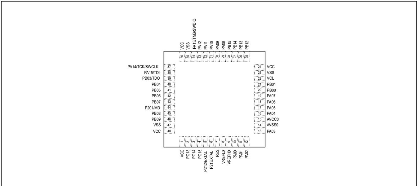
図 1.7 48 ピン QFN のピン配置
