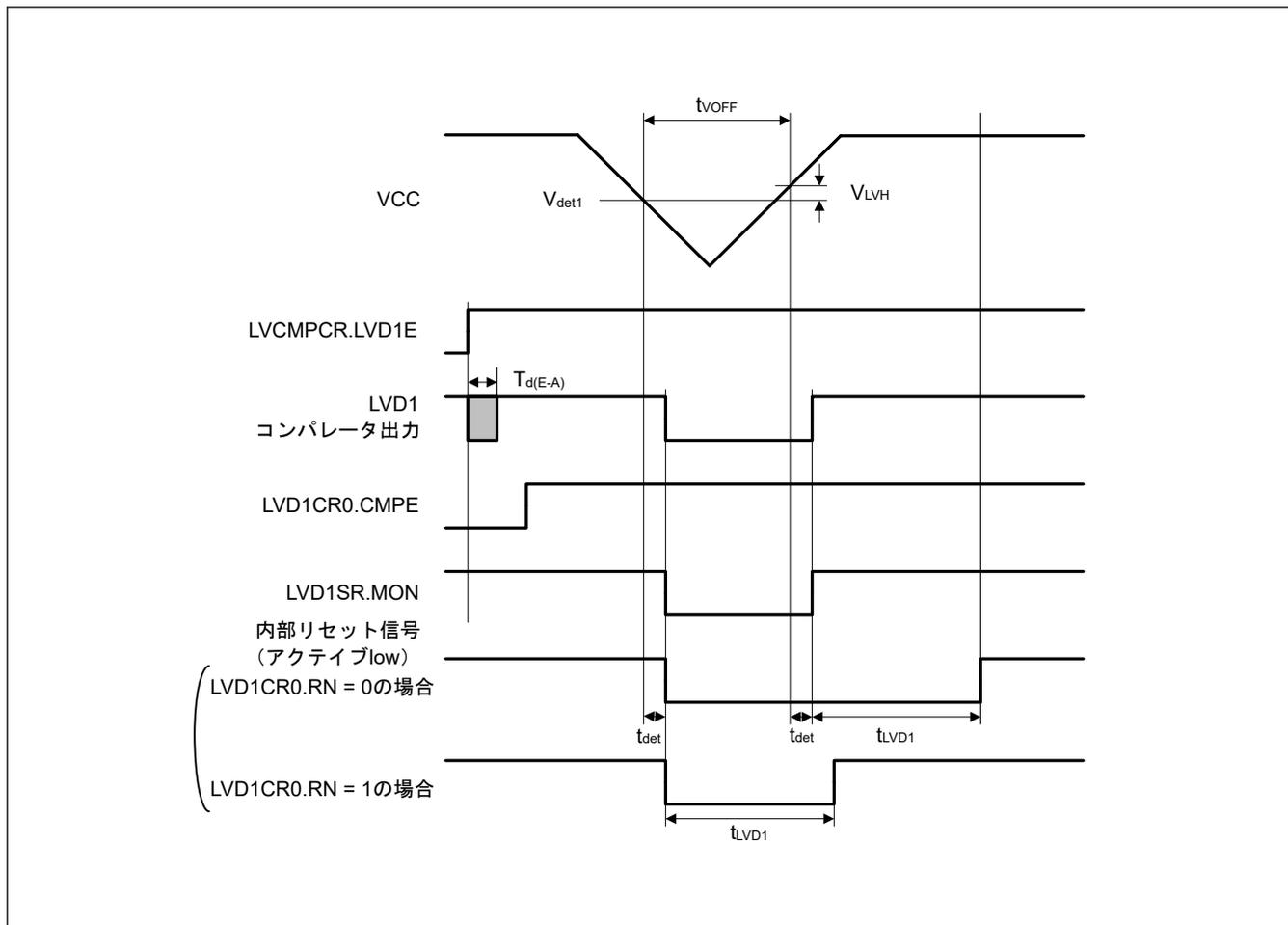
図 2.57 電圧検出回路タイミング ( $V_{det1}$ )
