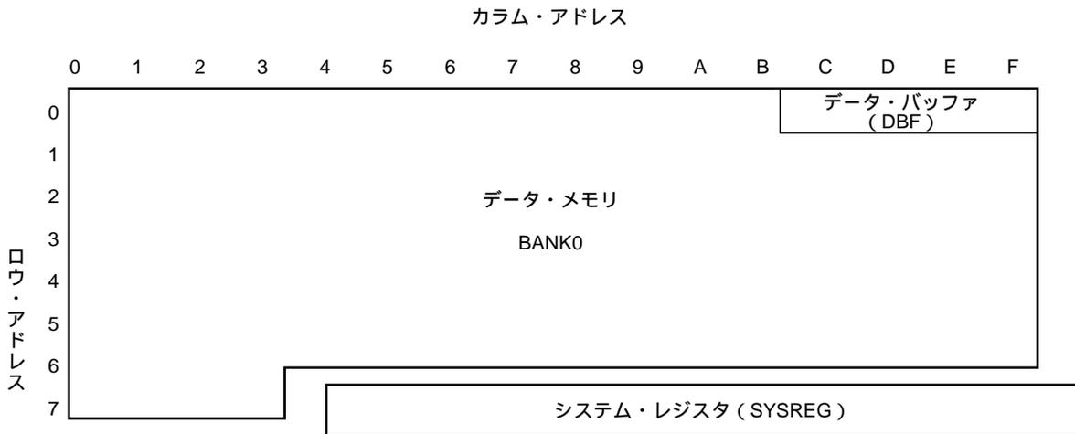
図9 - 2 にデータ・バッファの構成を示します。図9 - 2 に示すようにデータ・バッファはデータ・メモリの0FH番地のビット0をLSBとし、0CH番地のビット3をMSBとする16ビットで構成されています。
