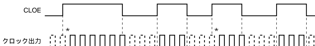
図12-4 リモコン出力応用例
