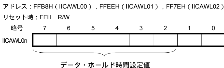
図16 - 9 IICAロウ・レベル幅設定レジスタ0n (IICAWL0n) のフォーマット
