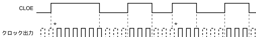
図11-6 リモコン出力応用例
