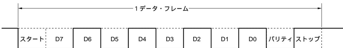
3. データ長: 8ビット, MSBファースト, パリティ: 偶数パリティ, ストップ・ビット: 1ビット, 通信データ: 55H, TxD6端子反転出力
