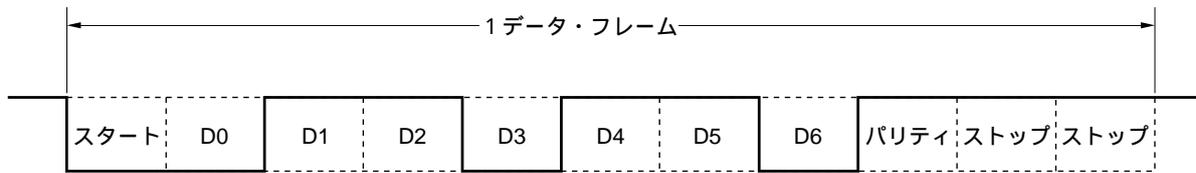
5. データ長 : 8ビット , LSBファースト , パリティ : パリティなし , ストップ・ビット : 1ビット , 通信データ : 87H
