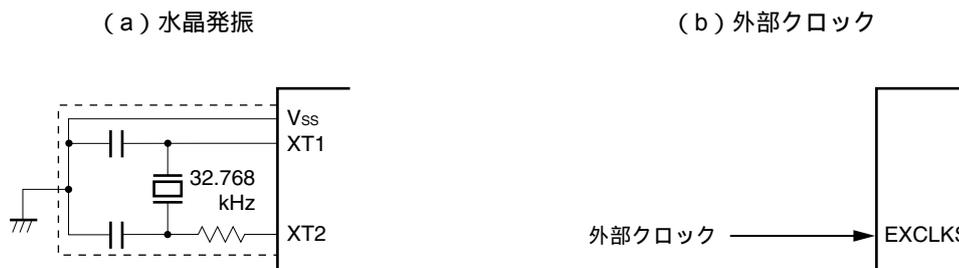
**注意1**．X1発振回路およびXT1発振回路を使用する場合は、配線容量などの影響を避けるために、図5 - 11, 図5 - 12の破線の部分を次のように配線してください。
