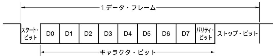
1データ・フレームは次に示すビットで構成されています。
