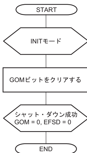
図13-84 通常シャット・ダウン処理
