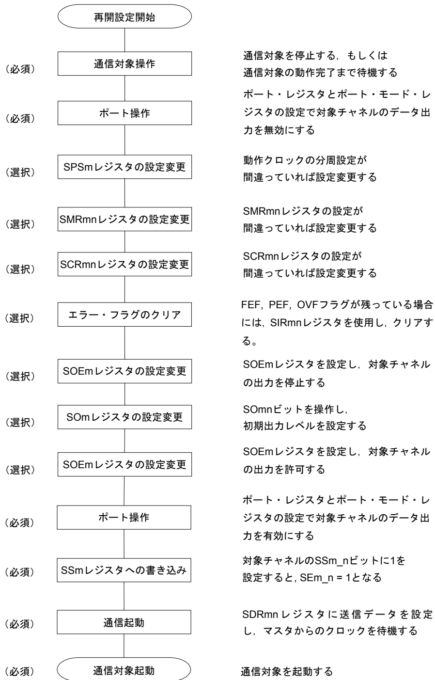
図11-68 スレーブ送受信の再開設定手順
