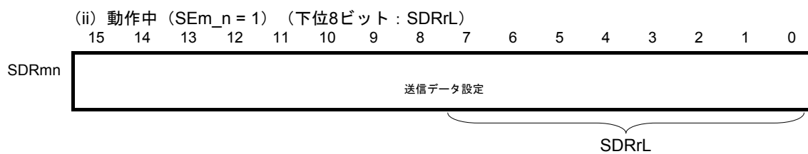
図11-144 簡易I 2 C (IIC11, IIC20) のデータ送信時のレジスタ設定内容例 (2/2)
