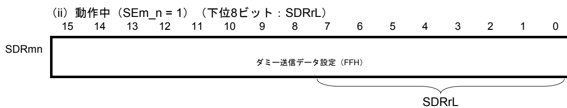
図11-147 簡易I 2 C (IIC11, IIC20) のデータ受信時のレジスタ設定内容例 (2/2)
