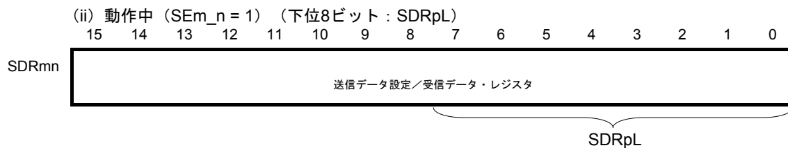
図11-92 SPI機能 (CSI00, CSI01) のマスタ送受信時のレジスタ設定内容例 (2/2)
