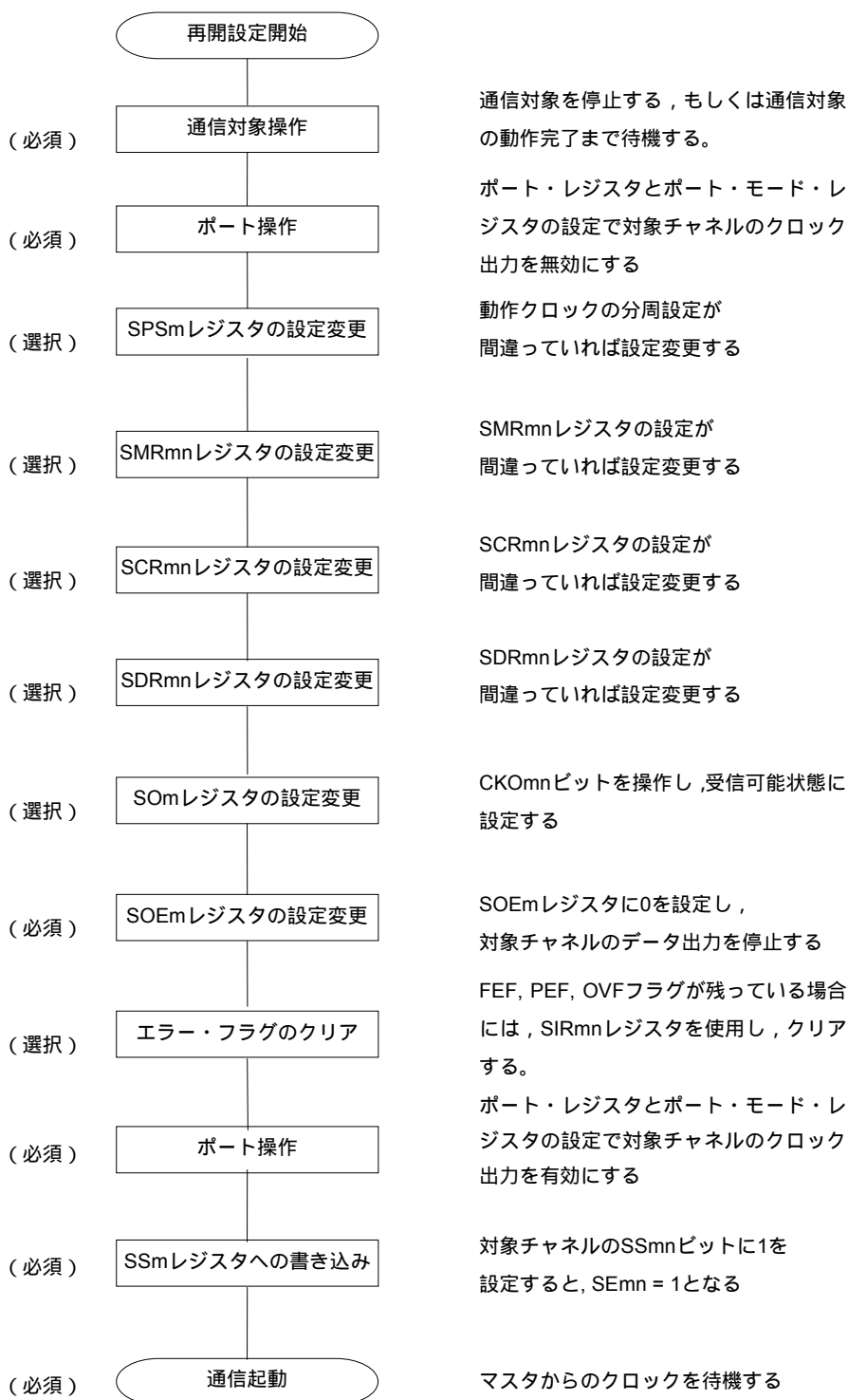
図14 - 57 スレーブ受信の再開設定手順
