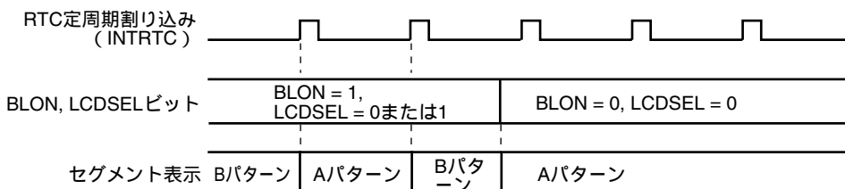
図16 - 36 点滅表示からAパターン表示への切り替え動作
