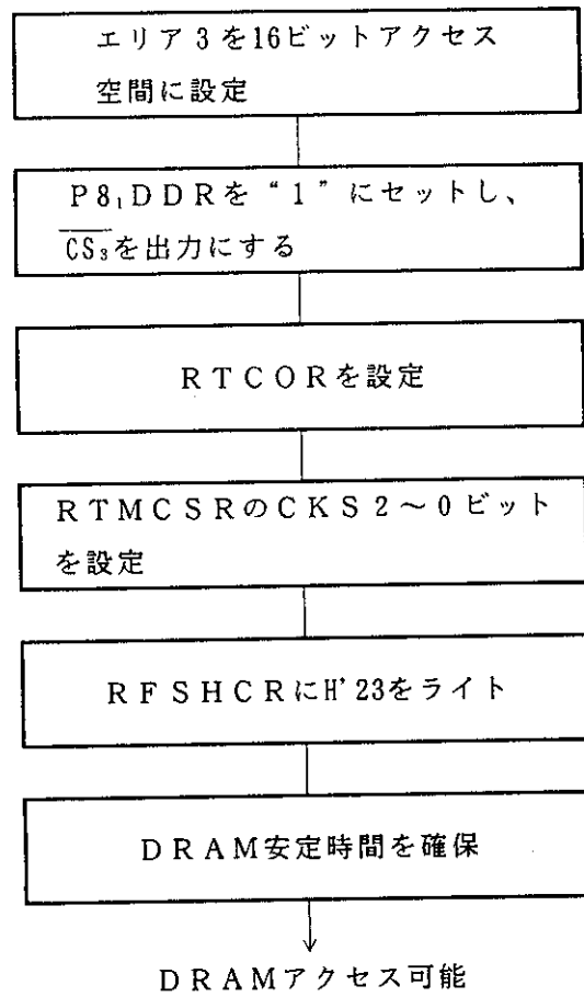
図 7.10 2WE方式4MビットDRAM (10ビットロウアドレス×8ビットコラムアドレスの場合) の設定順序 (16Mバイトモード)
